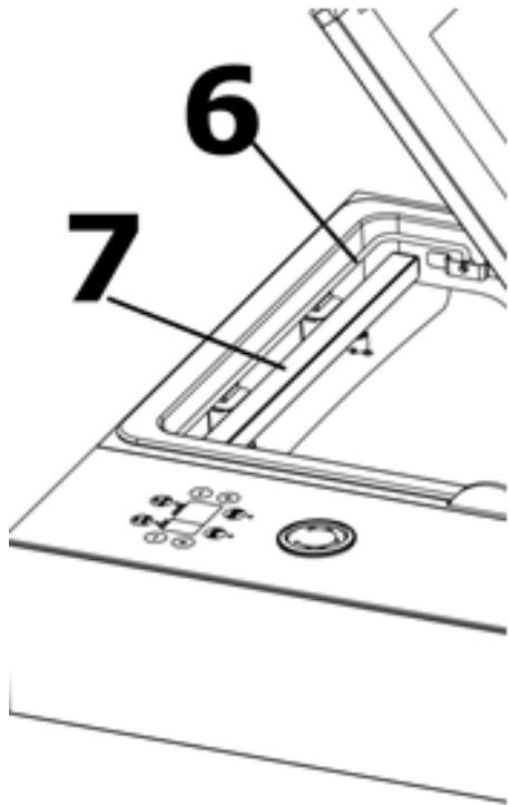
6 Fixierung: Zur Fixierung der Beutel während Vakuum- und Schweißvorgang. Anheben und zur Fixierung den Beutel nach unten klappen.
