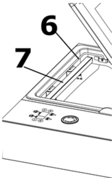
6 Fixering: För fixering av påsarna under vacuum-och svetsprocessen. Lyft och fall ned påsen för fixering.
