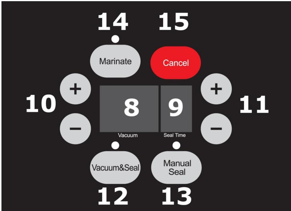
8 Vakumeringstid (Vacuum Time): numerisk display med två funktioner
