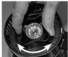
Legg beholderen med åpningen ned på bordet og skru bunnlåsen av ved å dreie med klokken. Du kan nå ta av knivinnretningen og tetningsringen. For montering, festes først tetningsringen på knivinnretningen. Pass på så tetningsringen sitter riktig på knivinnretningen. Sett bunnlåsen på beholderen og stram den mot klokken til den ikke kan skrus lengre.
