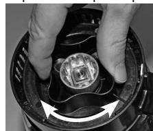
A questo scopo metterlo con l'apertura rivolta verso il basso sul tavolo e ruotare la chiusura del fondo in senso orario. È così possibile rimuovere il gruppo lama e l'anello di guarnizione.
