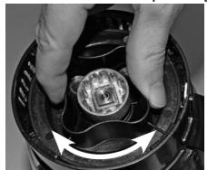
Stil den på bordet med åbningen nedad, og drej bundlåsen i urets retning. Nu kan knivdelen og tætningsringen tages ud. Ved montering anbringes tætningsringen først på knivdelen. Sørg for, at tætningsringen sidder korrekt på knivdelen. Sæt bundlåsen på mikserbeholderen, og drej den fast mod uret indtil anslag.
