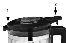
Sätt lockets hälipp snett under mixerbehållarens öppning och tryck fast locket lätt på mixerbehållaren (1).
