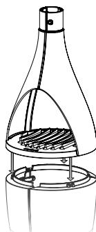
3. Plaats de vuurbox op de plint zodat de schaduwranden van de plint en vuurbox aansluiten.
