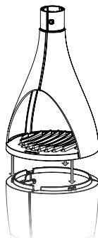
3. Placer brændkammeret på soklen, så skyggekanterne på sokkel og brændkammer flugter.
