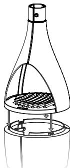
3. Placez le foyer sur le socle en vérifiant que les bords du socle et du foyer sont parfaitement alignés.
