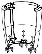
1. Bringen Sie den Sockel an an der Stelle auf einer flachen, soliden Fläche an, an der Sie die Outdoor Feuerstelle aufstellen möchten.
