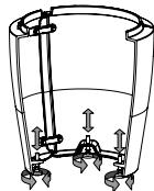
1. Placez le socle sur une surface robuste et plate pour garantir la stabilité du poêle dans le lieu choisi.
